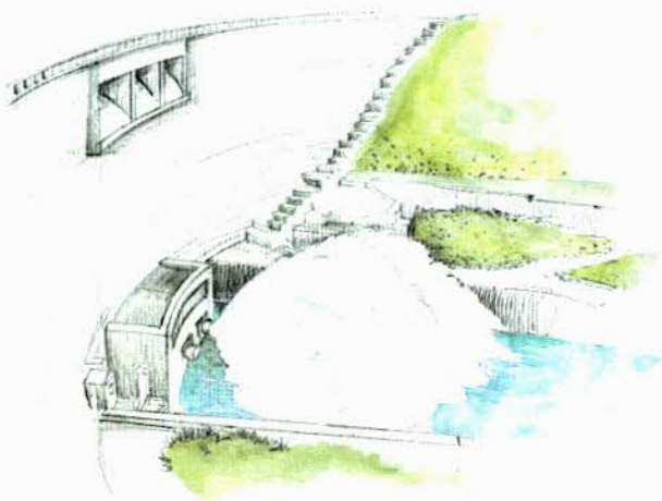
2 conduites de vidange équipées de jets creux (débit total maximum = 90 m 3 /s)
